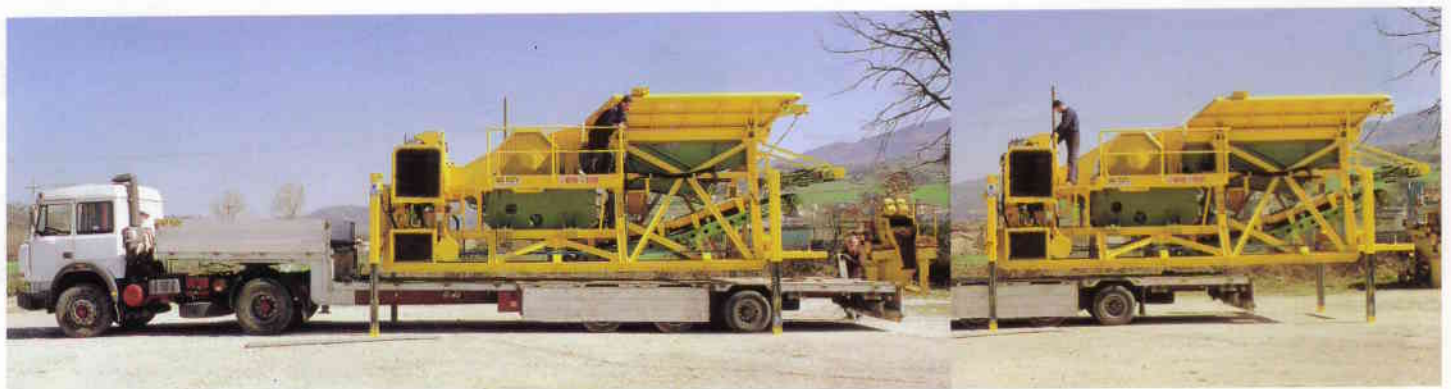
Eine Brechanlage beim Verladen auf einen Satteltieflader. Machine en condition de transport sur remorque rabaisée.
